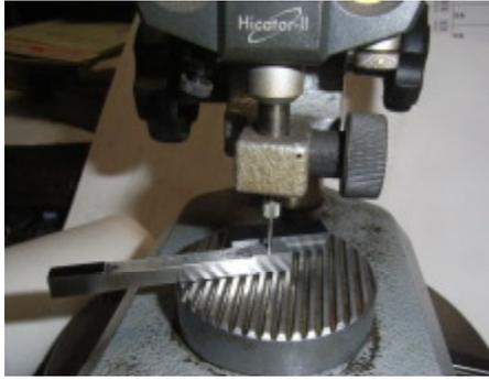
仕上がるべき寸法に組んだブロックゲージ寸法を0（ゼロ）規準にして、それとの寸法差が0（ゼロ）となるようにラップしていきます。
