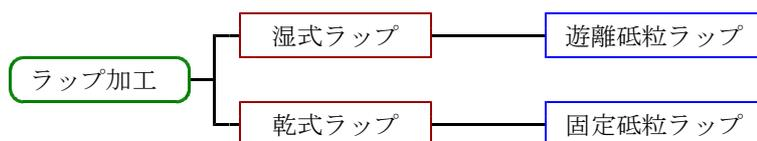
遊離砥粒ラップというのは、ラップ工具面上にラップ砥粒とラップ油の混和したものを展開させ、一定の加圧力の下でラップ作業を行うものです。この場合のラップ作業の研磨力というのは、砥粒が破碎されるこ
