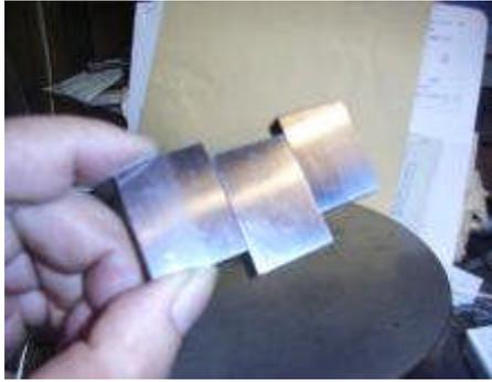
比較的小さな寸法のブロックゲージをサンプルの間に挟み込みます。
